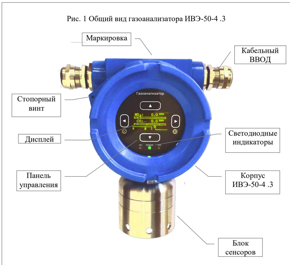
Газоанализаторы ИВЭ-50-4 .3 являются универсальными устройствами для визуализации сигналов загазованности, принимаемых от газовых сенсоров и дальнейшей передачи этих сигналов на внешнее оборудование автоматического контроля и сигнализации. Результаты измерений содержания определяемых компонентов отображаются на дисплее и снимаются со стандартных выходов ИВЭ-50-4 .3 в виде аналогового токового сигнала в диапазоне (4 – 20) мА, а также в виде данных цифрового канала связи RS-485 Modbus.
